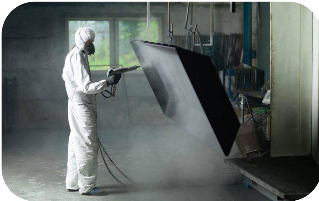
تصویر ۱: روش رنگ‌پاشی پودری الکترواستاتیک در صنعت
